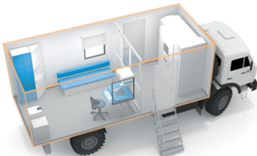
Флюорографический кабинет располагается в фургоне, который функционально разделен раздвижной перегородкой, изготовленной из
