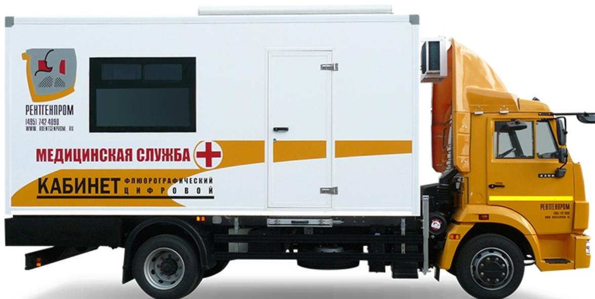
Кабинет флюорографический подвижной с цифровым флюорографом КФП-Ц-РП
