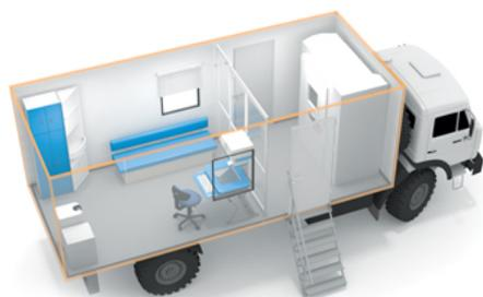
Флюорографический кабинет располагается в фургоне, который функционально разделен раздвижной перегородкой, изготовленной из полупрозрачного поликарбоната, на две части: процедурную и кабинет для медперсонала.
