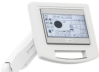
Пульт управления отображает установленные параметры, показание дозиметра, длительность исследования при ручном, автоматическом режиме, а также в режимах предустановки по органам.
