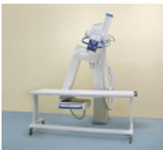
Основным штативным устройством является штатив снимков, состоящий из колонны, по которой вертикально перемещается поворотная штанга с изменяемым фокусным расстоянием. Штанга представляет собой уравновешенную консоль, с размещением на одном конце поворотного кронштейна с излучателем и диафрагмой, а на другом — поворотного кронштейна с кассетодержателем. Кассетодержатель позволяет работать со всеми размерами кассет от 13×18 см до 35×43 см.
